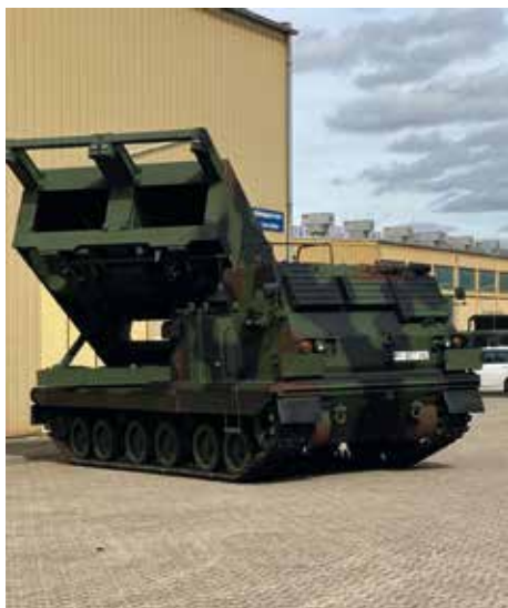
Raketenwerfer MARS II hat drei Mann Besatzung und kann 12 Raketen verschießen.
