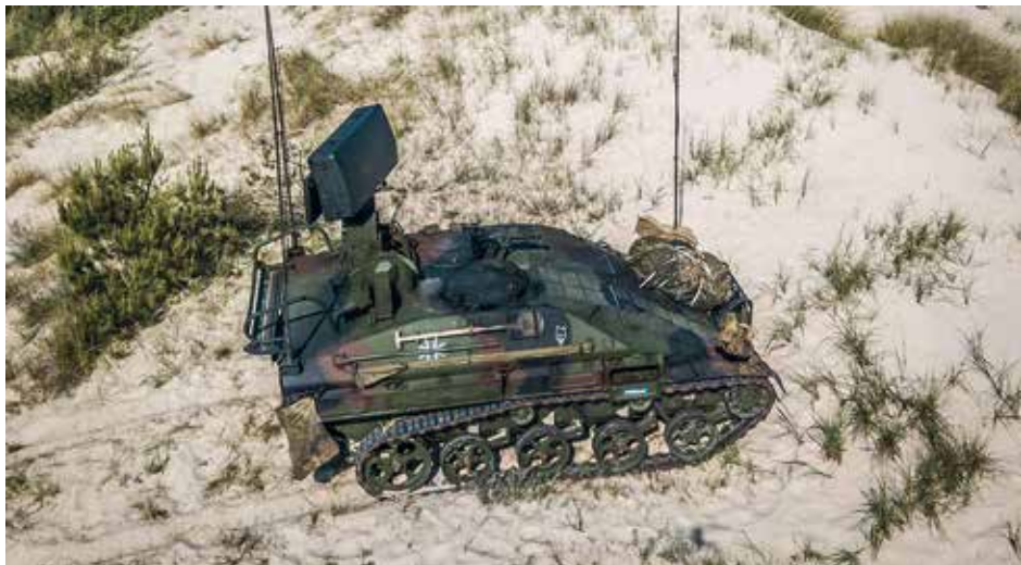
Das Aufklärungs-, Führungs- und Feuerleitfahrzeug klärt den Luftraum auf und gibt die Kommandos an die Waffenträger Ozelot weiter (Quelle: Bundeswehr/Christian Timmig)
