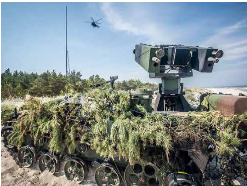
Der Ozelot bekämpft die feindlichen Luftfahrzeuge mit Stinger-Lenkflugkörpern in einer Entfernung von bis zu 6.000 Metern. (Quelle: Bundeswehr/Christian Timmig)
