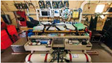
Eine Patiententransporteinheit auf intensivmedizinischem Standard an Bord einer Transall C-160 MedEvacMedical Evacuation in Niamey/Niger im Rahmen der UNUnited Nations-Mission MINUSMAMultidimensionale Integrierte Stabilisierungsmmission der Vereinten Nationen in Mali (Quelle: Bundeswehr/Norman Möller)
