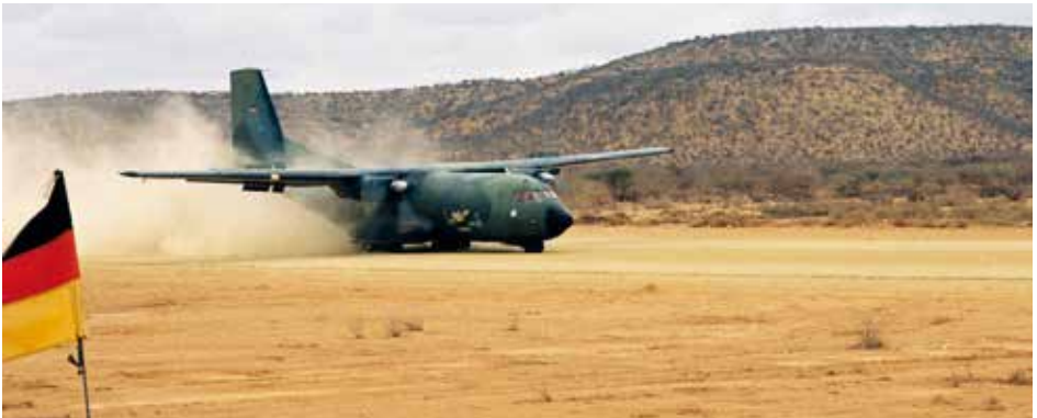
Die Transall ist dank des speziellen Fahrwerks und des Staubresistenten Turboprop Antriebs fähig, auf unvorbereiteten Pisten zu landen (Quelle: Bundeswehr/Archiv)
